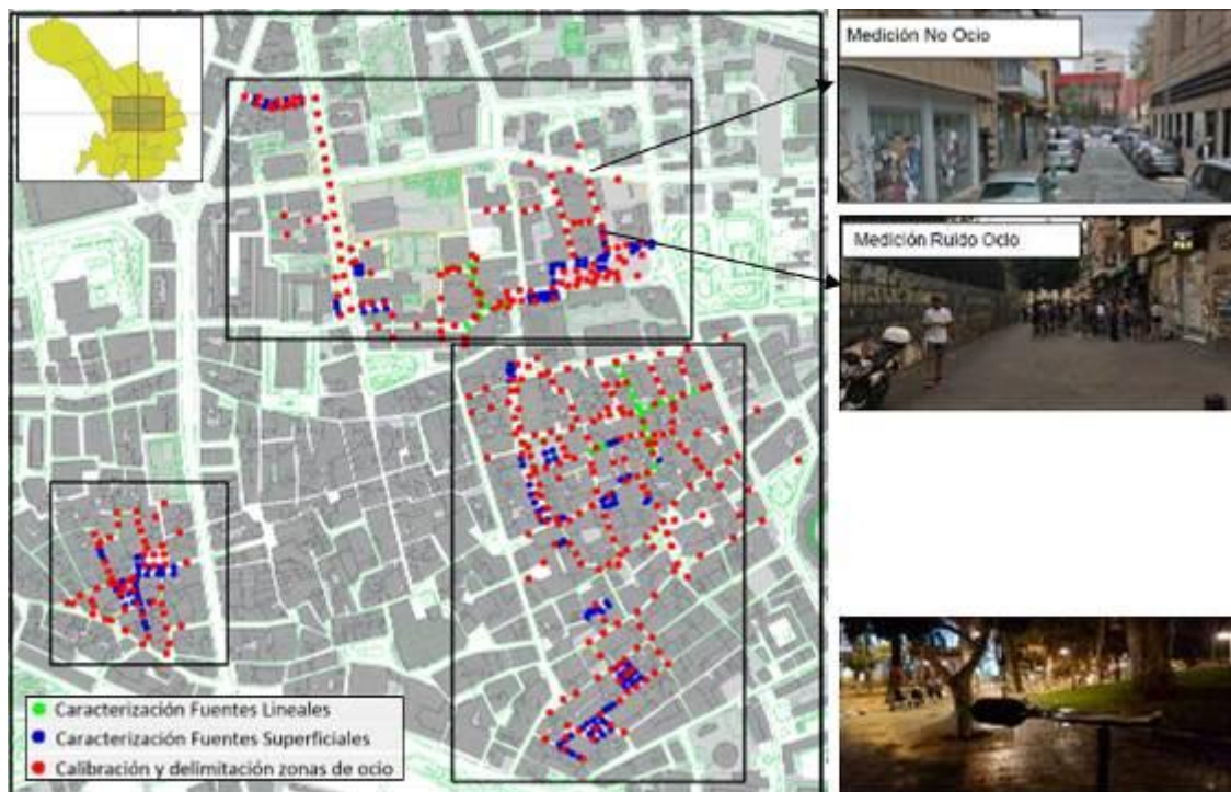
Imagen 6: Localización mediciones de corta duración, e identificación de mediciones para delimitación zonas de ocio
